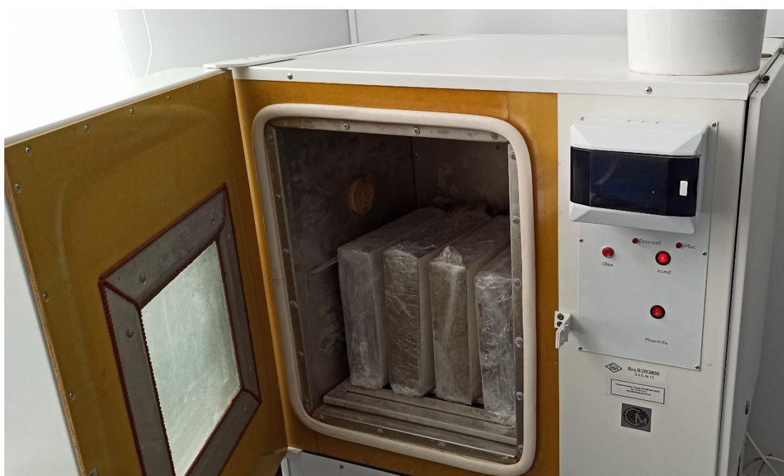
Рис. 1.2 Опытные образцы в климатической камере
