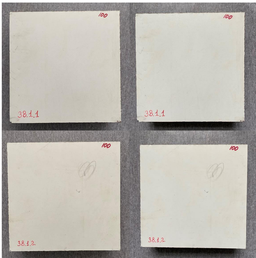
Рис. 2.4 Вид образцов до (слева) и после (справа) прохождения 100 циклов замораживания и оттаивания
