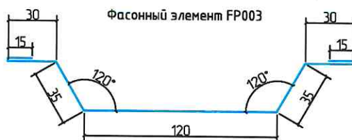
Рис.2. Узел примыкания к ж/б несущему элементу
